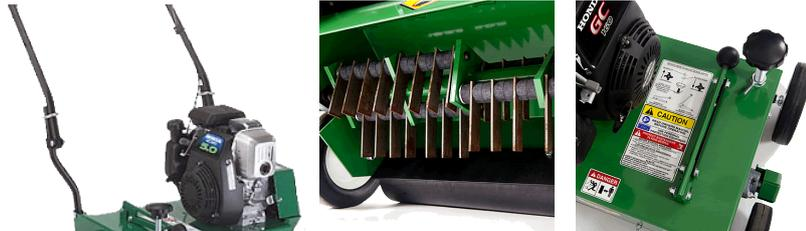
Der Vertikutierer CR 550 HC hat serienmäßig abschmierbare und robuste Wellenlager und ist für Flächen von bis zu 1000 m<sup>2</sup> geeignet. Durch seine kompakte Bauweise und den klappbaren Holm bietet sich dieses Gerät vor allem für die Vermietung an. Eine leicht verständliche Höhenverstellung und kugelgelagerte Metallräder gehören ebenfalls zur Standardausrüstung.
