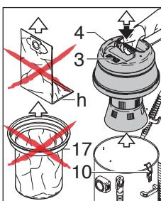
☞ Sauger ausschalten (3). Die 2 Kessel-Arretierriegel (10) öffnen und Motorkopf (4) nach oben abnehmen.
