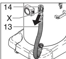
☞ Entleerungsschlauch (13) von der Halterung (X) abnehmen.
