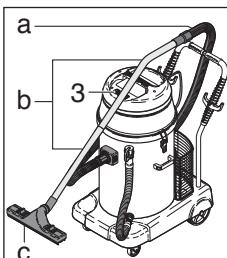
☞ Wickeln Sie das Netzkabel (9) vollständig ab. Montieren Sie das gewünschte Zubehör (z.B. Wasseraugdüse (c)).
