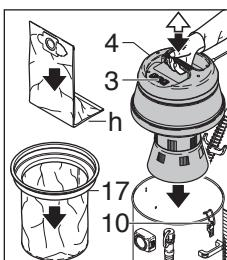
☞ Sauger ausschalten (3). Die 2 Kessel-Arretierriegel (10) öffnen und Motorkopf (4) nach oben abnehmen.
